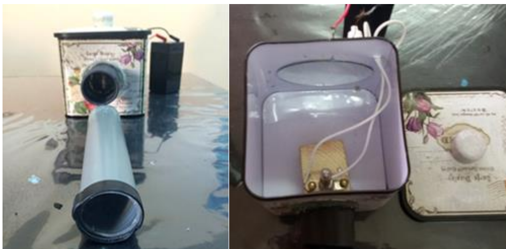
Figura 4: La foto de la izquierda muestra nuestra linterna mágica hecha con una lata de galletas , dos lentes convergentes y un trozo de tubería de PVC. La foto a la derecha muestra el interior de la lata en el que está colocado el espejo cóncavo y la bombilla.
