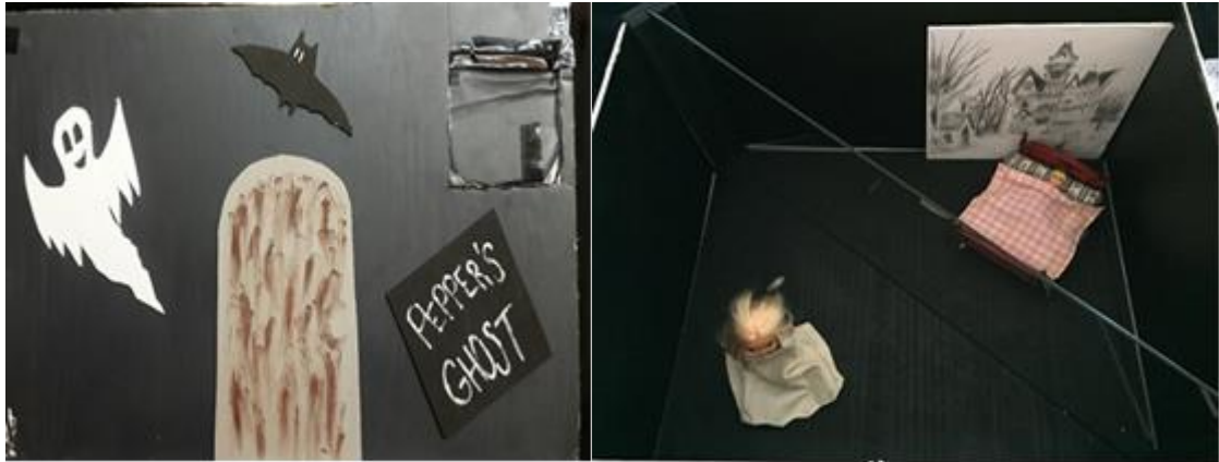
Figura7 : Nuestra maqueta dePepper's Ghost. A la derecha el interior con un cristal a 45°.
