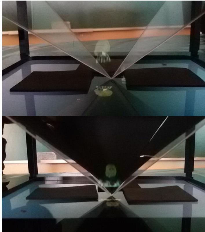
Figura 12: Foto superior, cubrimos 3 de las imágenes del video y el “holograma” es aún visible. Foto inferior cubrimos las 4 caras de la pirámide y el “holograma” continúa visible.
